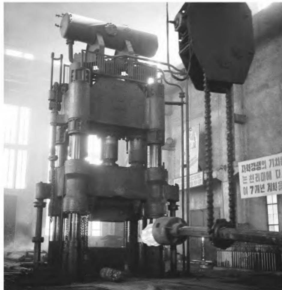
龙城的工人阶级制造出来的三千吨压力机
